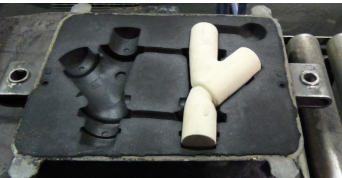
maximale Materialersparnis durch formgenaue Sandkerne
