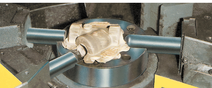
Minimierung des Einsatzgewichtes durch das Hohlpressverfahren
